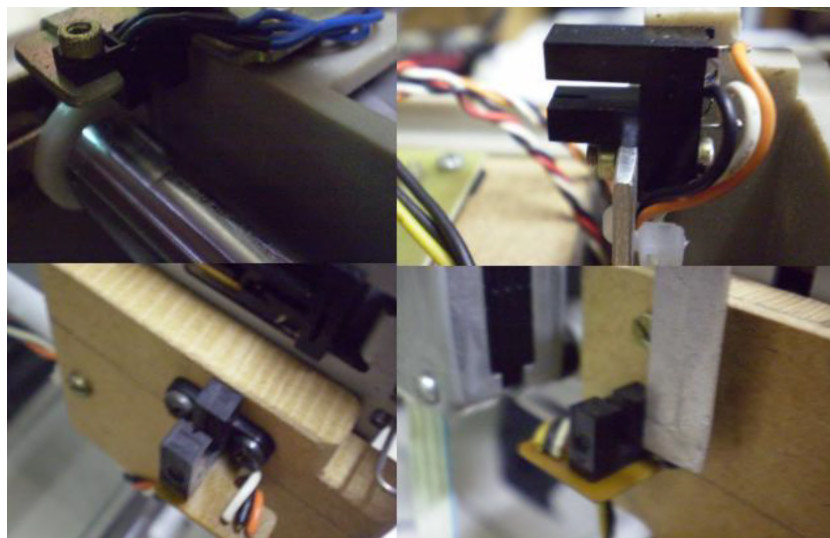
Figura 10 – Sensores foto-acopladores de final de curso dos eixos X e Y.
