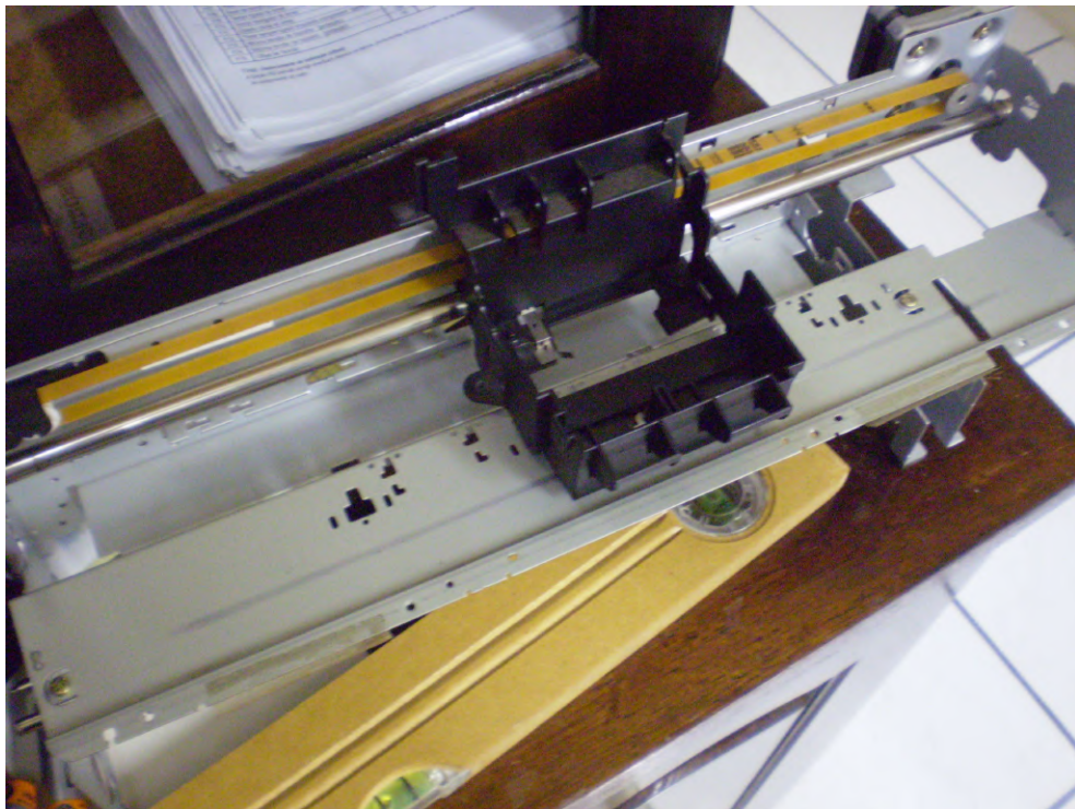
Figura 6 – Parte da impressora jato de tinta utilizada como eixo Y do CNC.
